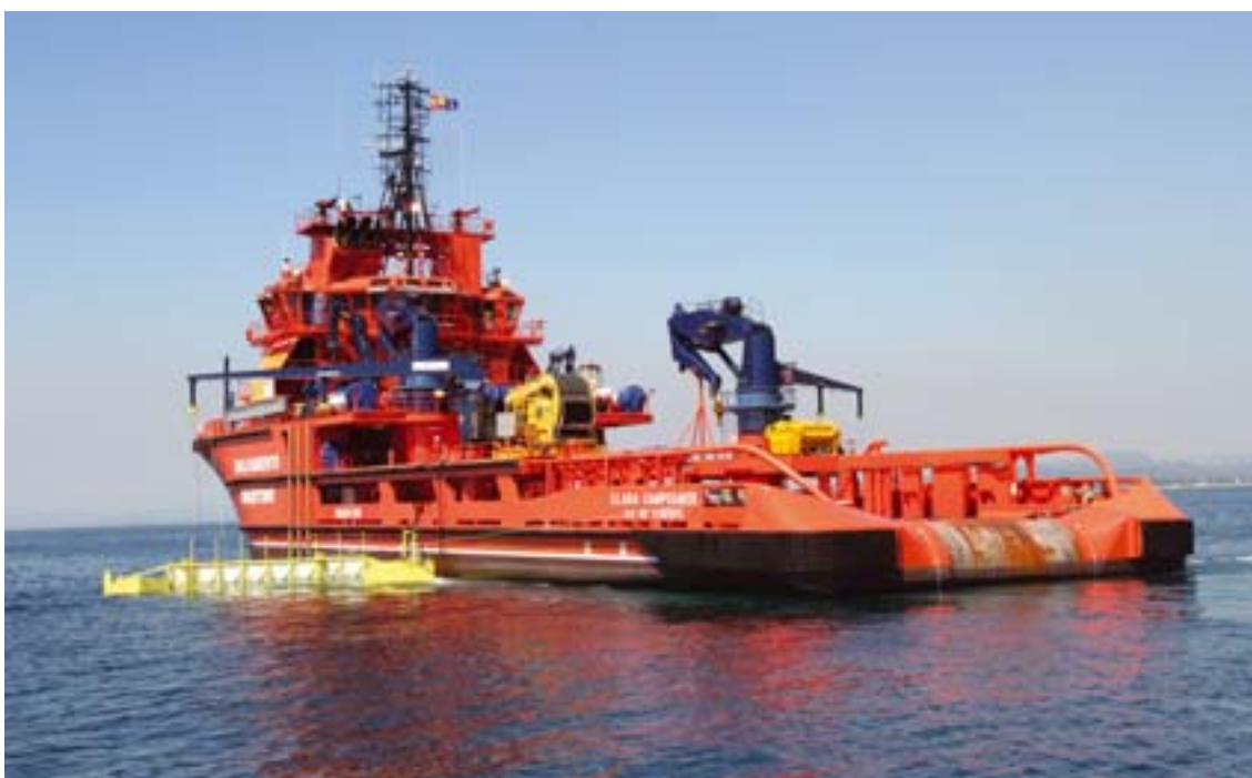
El buque polivalente de salvamento y lucha contra la contaminación marina “Clara Campoamor” desplegó sus brazos de recogida en el ejercicio.
