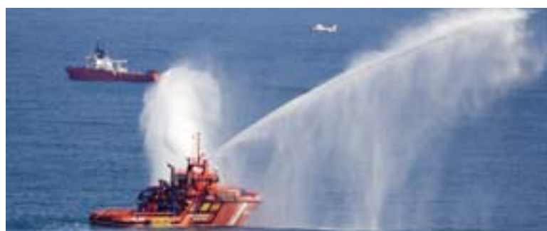
El buque "Don Inda" dispone de un sistema contra incendios para otros buques situados hasta una distancia de 160 m y 70 m de altura.
