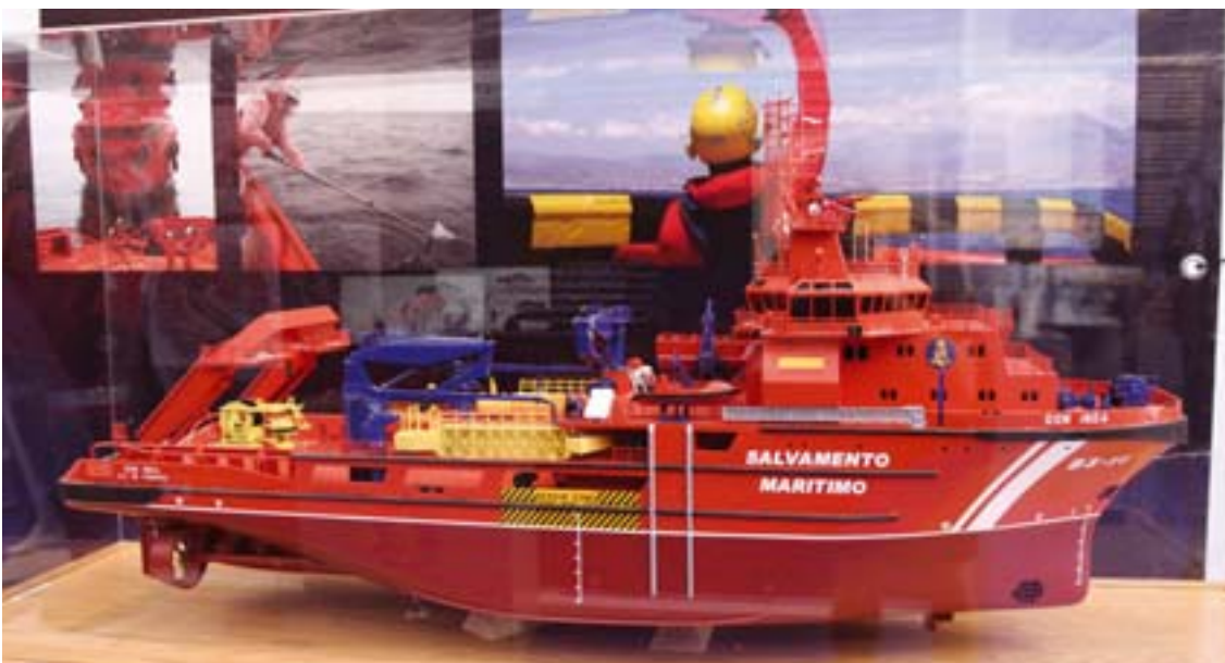
Maqueta del buque polivalente de salvamento y lucha contra la contaminación "Don Inda", de 80 metros, 228 toneladas de tiro y una capacidad de recogida, almacenamiento y trasvase de 1.749,8 metros cúbicos de residuos de la mar mediante un sistema de brazos de barrido.
