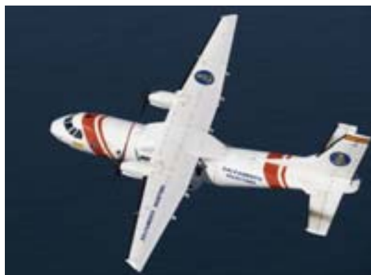
Con un tiempo de permanencia en el aire superior a las 9 horas, el CN 235-300 puede intervenir en operaciones con un alcance de 3.706 kilómetros y un radio de acción de 1.853 kilómetros, con una velocidad de 437 kilómetros por hora.
