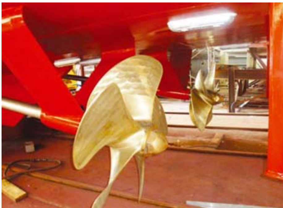
> Vista de la obra viva de un casco de aluminio ya pintado con el antifouling y donde se aprecian metales de diferentes tipos así como los ánodos de protección.
