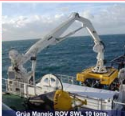
Grúa Manejo ROV SWL 10 tons.
