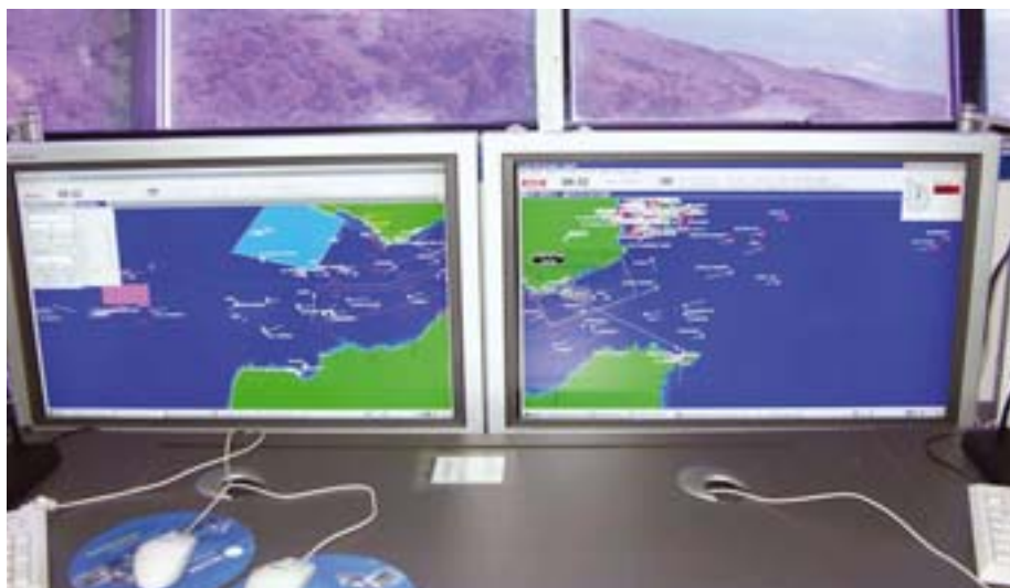
➤ Tarifa Traffic y Tangier Traffic cuentan con un sistema AIS y un LSD situados localmente y a distancias con el fin de proporcionar una cobertura adecuada de la zona.
