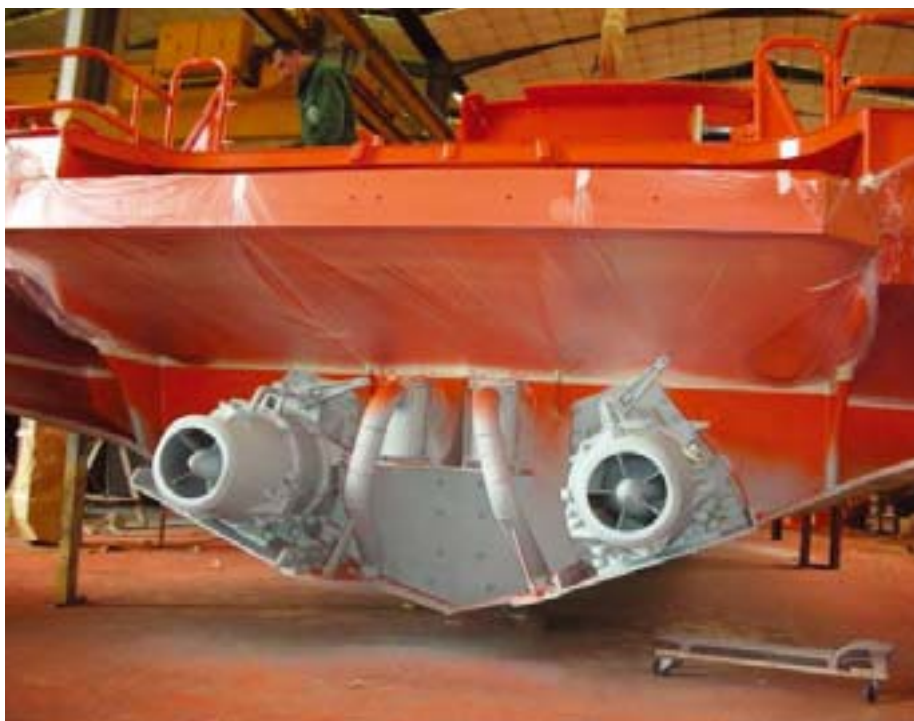
➤ En esta imagen se pueden apreciar diferentes partes de un proceso de pintado en zona de propulsores y casco, en este caso water - jets
