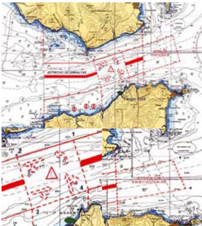
> Modificación del Dispositivo de Separación de Tráfico, elaborado por España y Marruecos y aprobado por la OMI, en el Estrecho de Gibraltar.
