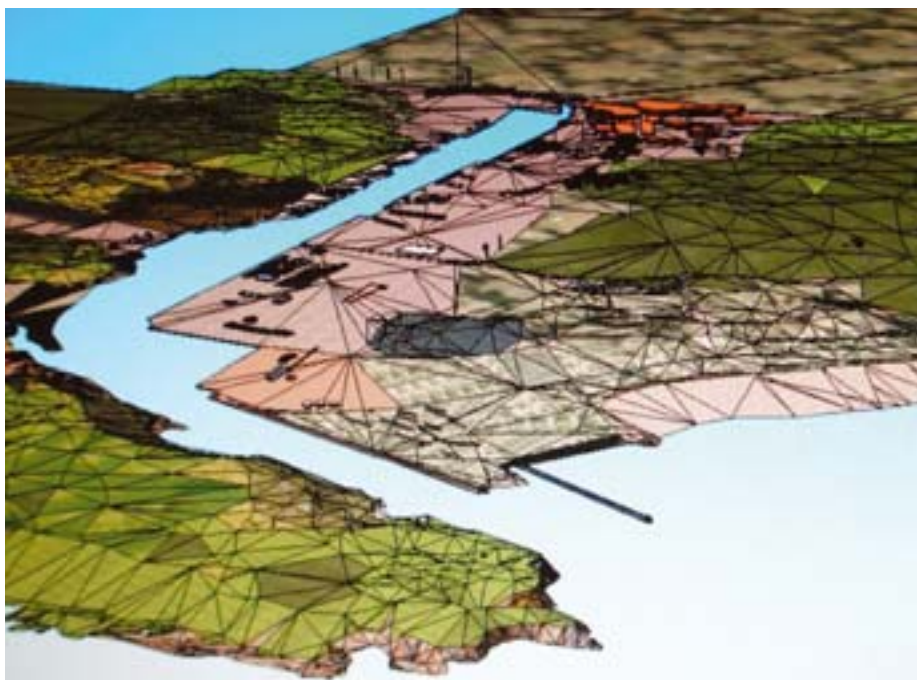
> La imagen visual acabada de Avilés, con toda la superficie triangulada, imitando el relieve y con las texturas ya “adheridas” a los triángulos.
