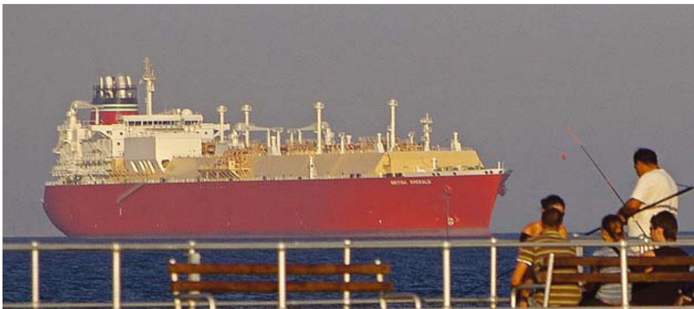
> El buque tanque LNG “British Emerald”, entregado en 2006 a BP, es uno de los primeros metaneros en emplear el sistema de propulsión Dual Fuel Diesel Electric (DFDE).
