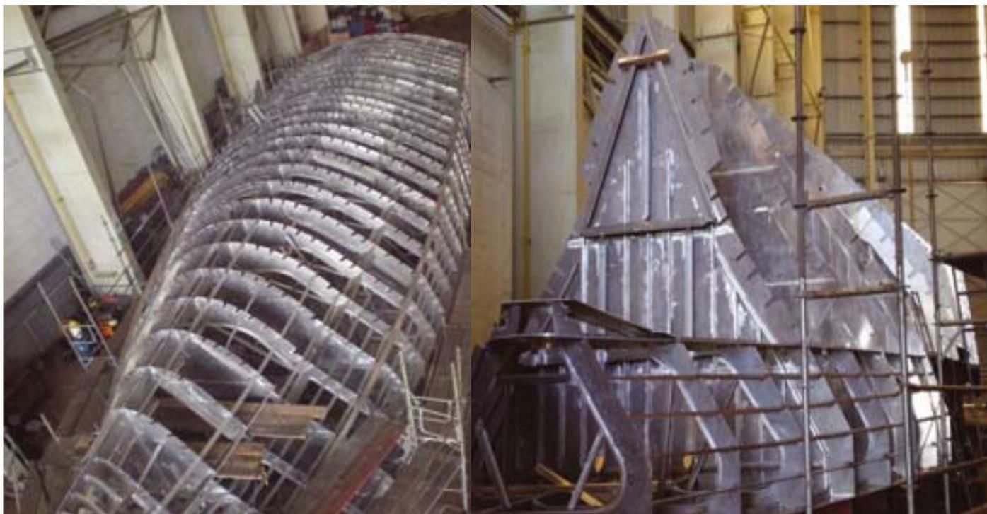
> Diversas fases de construcción de un casco en aluminio.
