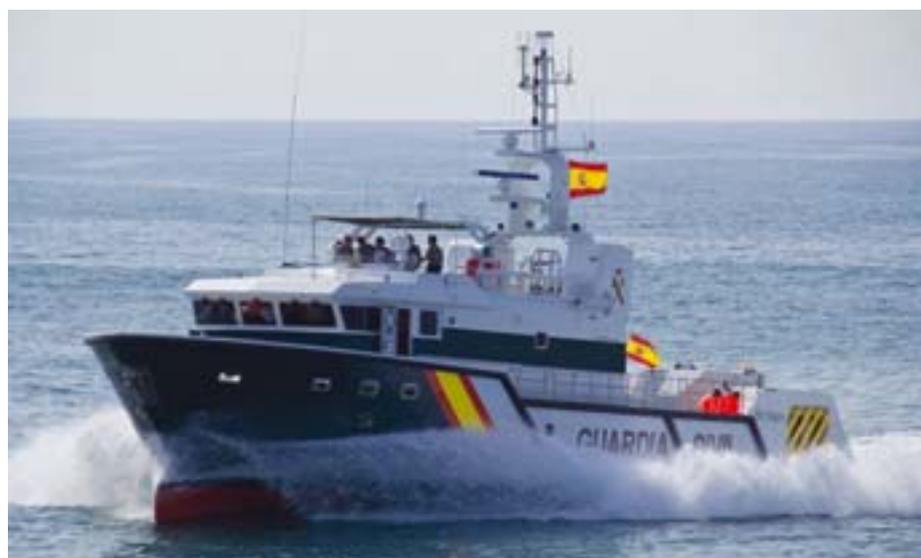
> Navegando a alta velocidad el A-20 "Río Segre" muestra el bulbo de proa con formas angulares. (Foto: ASFIBE.)
