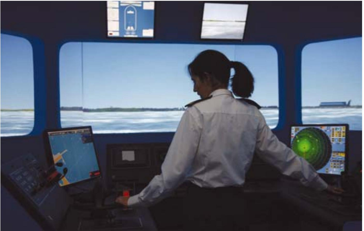
> Puente del simulador de remolcador tipo *Schottel* instalado en el Centro “Jovellanos” que puede interactuar en tiempo real con un buque principal.
