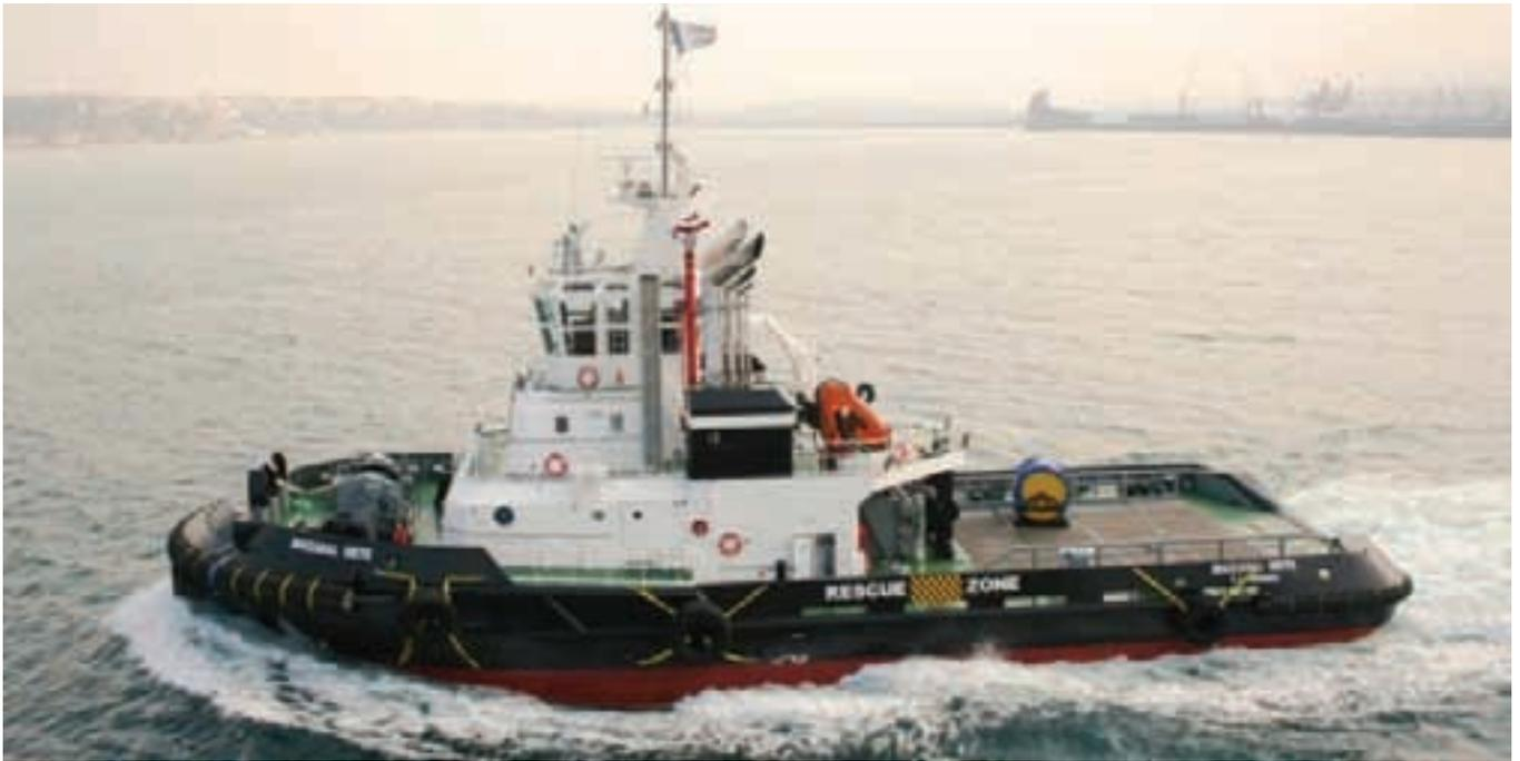
▲ El remolcador “Ibaizábal Siete” (año 2007), equipado con propulsión azimutal con toberas. Eslora de 37 m y manga de 14 m. Su BP es de 105 toneladas.
