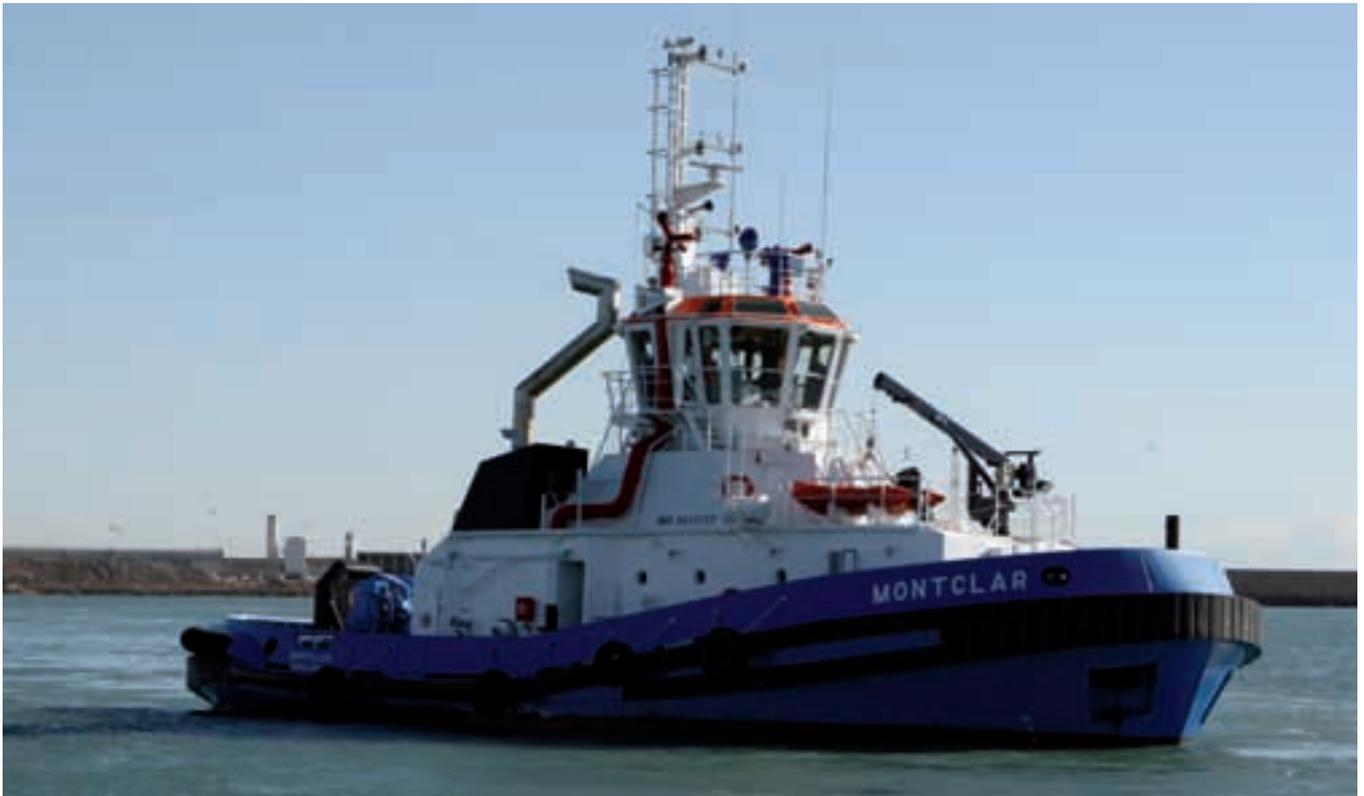
▲ Remolcador "Montclar" de Remolques de Barcelona (REBARSA). Es el último de una serie de seis remolcadores encargados por la naviera a los astilleros Zamakona. Se trata de un tractor azimutal con 80 toneladas de BP y capaz de recoger vertidos contaminantes del agua (Oil recovery ship).
