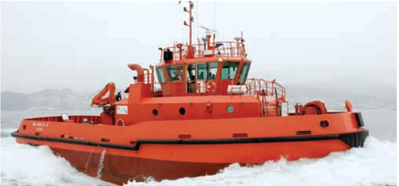
▲ Construido por la Factoría Naval Marín, el “Blanca S” de Remolcadores Nosa Terra (Remolcanosa). Eslora de 24 m; manga de 10 m; puntal de 4,75 m. BP de 53 toneladas.
