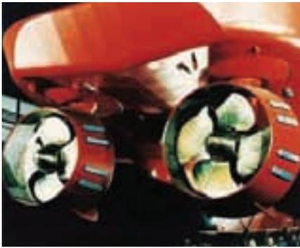
▲ Propulsión azimutal con tobera.
