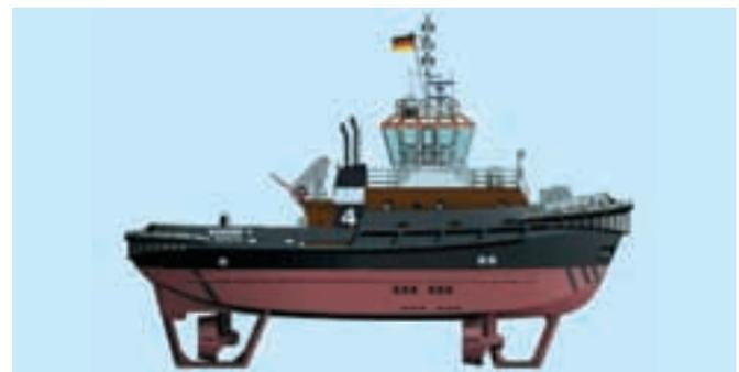
▲ Esquema de tractor plus. Las dos hélices-timón de proa se complementan con otra a popa.
