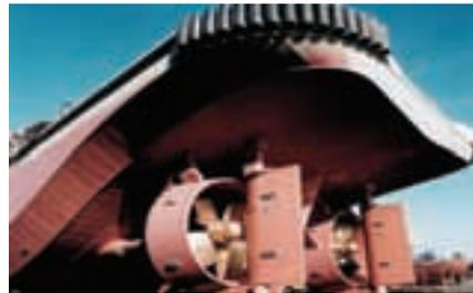
▲ Propulsión en un remolcador convencional avanzado. Hélices de paso variable y toberas.
