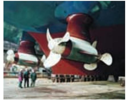
▲ Doble hélice azimutal.
