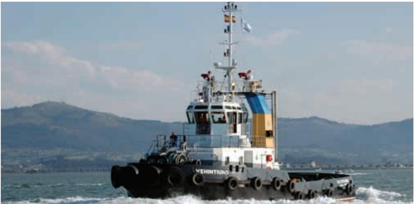
▲ El “Veintiuno” de Remolques Unidos, dispone de dos propulsores azimutales Shottel SRP 1515. Eslora de 31,50 m; manga de 11,20 m; puntal de 5,40 m; calado de 4,20 m. BP de 75 toneladas.
