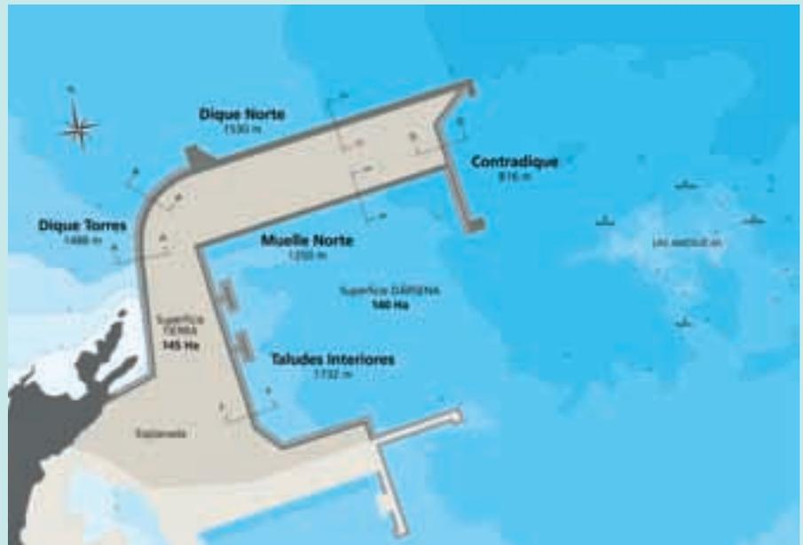
▲ Detalle de la ampliación. Entre el dique Norte y el muelle Norte se ubicará la terminal de graneles sólidos. Cerca del cabo Torres, la nueva explanada recibirá la planta de regasificación.
