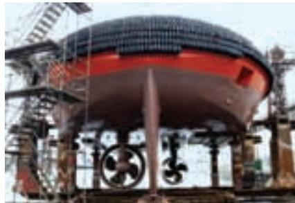
▲ Imagen de la carena de un ATT, con las hélices-timón azimutales desplazadas. Se aprecia la rugosidad de las defensas perimetrales.
