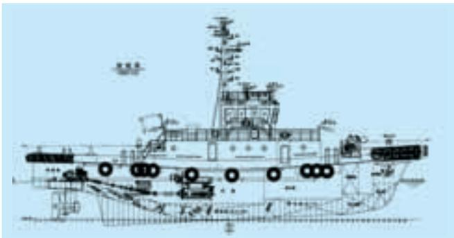
▲ Perfil de remolcador Z-Peller (ASD) con dos azimutales a popa.
