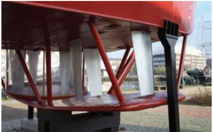
▲ Dos propulsores Voith en un tractor, con su estructura de protección.
