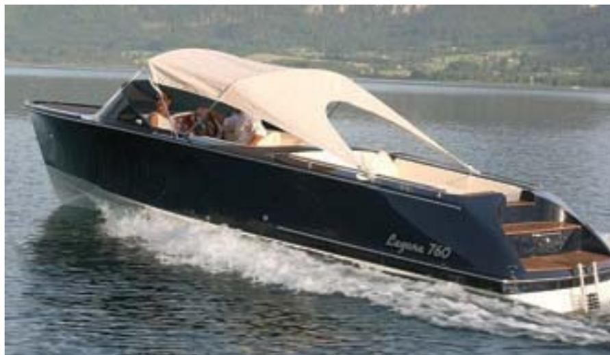
▲ Lancha rápida "Laguna 760" de la firma alemana Boote Marian. Toda eléctrica, con un motor de 40 Kw, puede llegar a navegar a 20 nudos. Su autonomía media es de seis horas, aunque a velocidad reducida alcanza las ocho horas.
