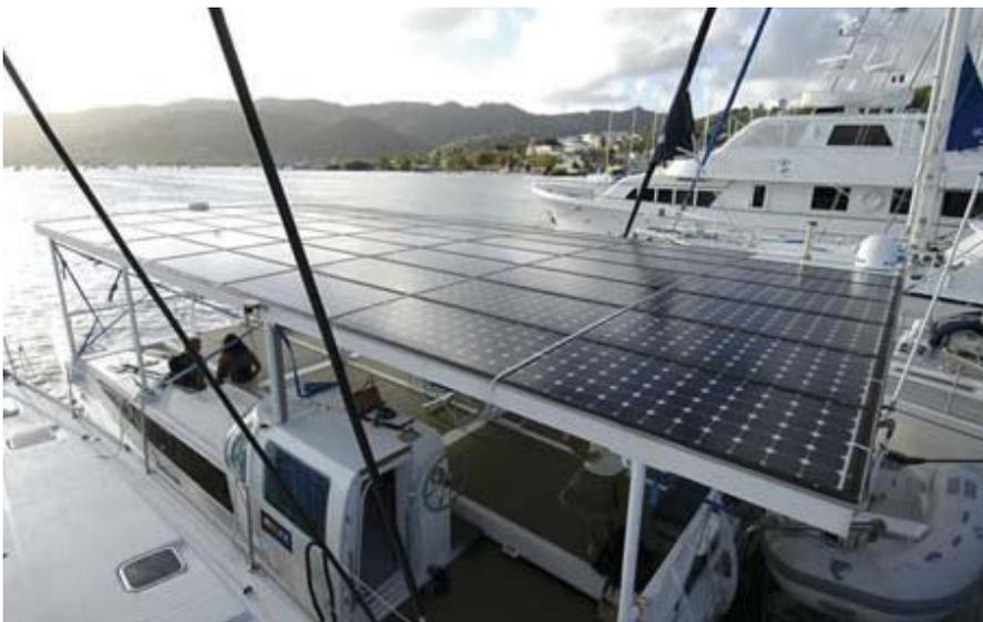
▲ Sobrecubierta tapizada de paneles solares en el “Aquabus C60”, de MW Line. La firma suiza se especializa en catamaranes electrolares de uso turístico y anuncia costes de explotación 45 veces inferiores al de un catamarán similar con motor diesel.
