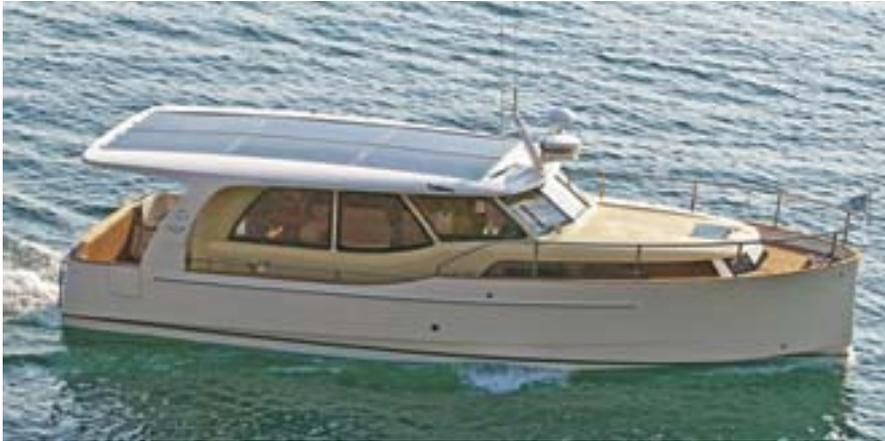
▲ El yate híbrido "Green Line 33", producto de J&J Design y de la firma ítalo eslovena Seaway, dispone de un motor Volkswagen Marine convencional. Utiliza un techo solar de 1,3 Kw para recargar baterías y en modo eléctrico se desplaza hasta 20 millas de distancia a seis nudos de velocidad. Obtuvo el Premio Powerboat 2010 en la feria náutica de Düsseldorf (Alemania).
