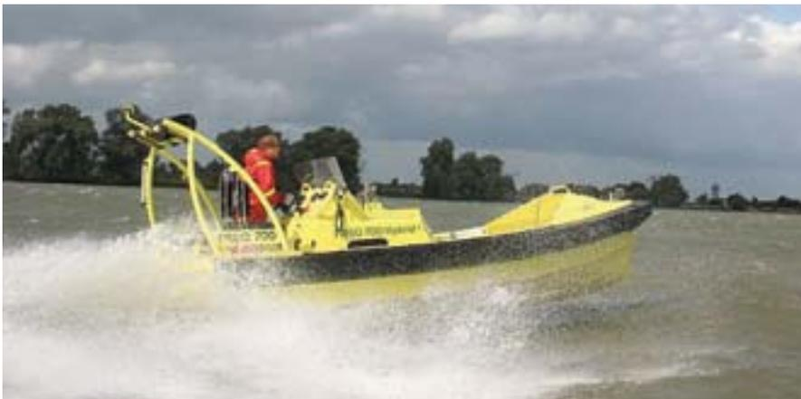
▲ Lancha de salvamento holandesa, en aluminio, "FRSQ 700 Hybrid". Construida por la empresa Fast RSQ, alcanza los 34 nudos, aunque en modo eléctrico el hidrojet la propulsa a seis nudos durante las maniobras en puerto.
