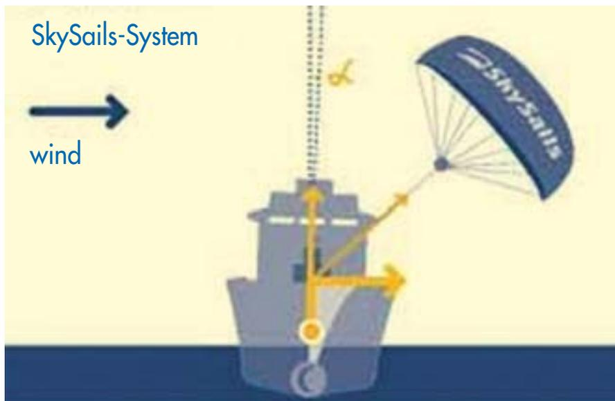
▲ Figura 1: Esquema de tracción y funcionamiento del sistema de propulsión Skysails.
