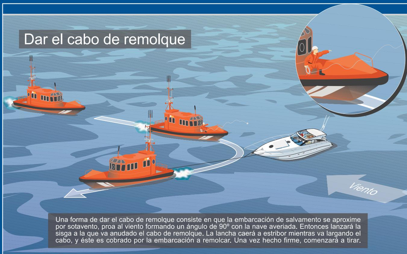
Una forma de dar el cabo de remolque consiste en que la embarcación de salvamento se aproxime por sotavento, proa al viento formando un ángulo de 90° con la nave averiada. Entonces lanzará la sisca a la que va anudado el cabo de remolque. La lancha caerá a estribor mientras va largando el cabo, y éste es cobrado por la embarcación a remolcar. Una vez hecho firme, comenzará a tirar.
