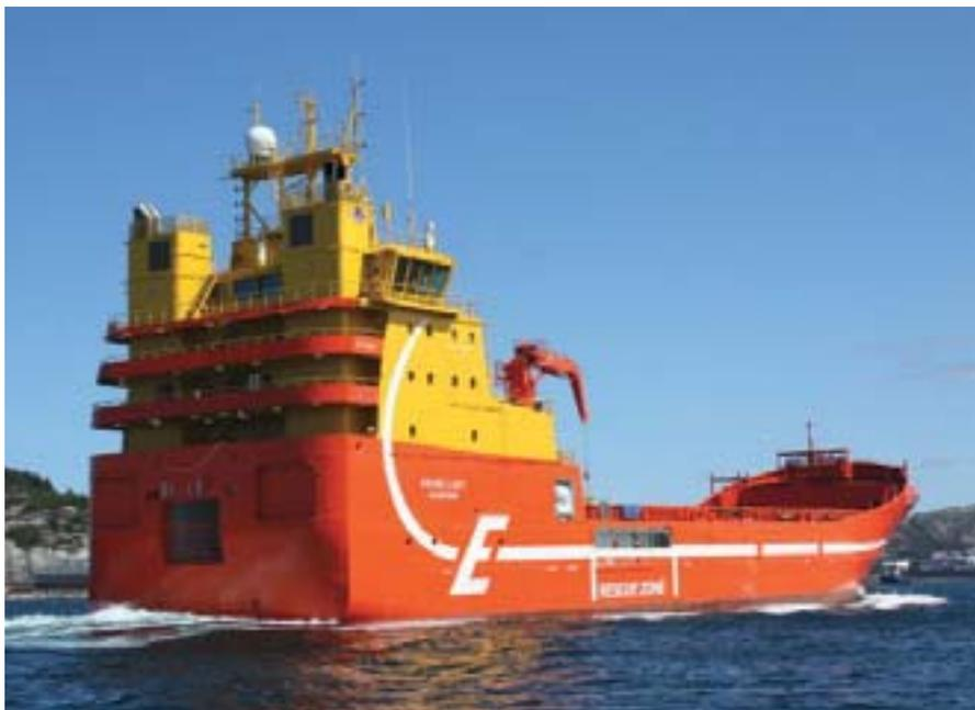
▲ Ejemplo de soluciones tecnológicas, el *supply* "Viking Lady", de 5.900 GT y 92,2 metros de eslora, utiliza gas natural como combustible del motor principal y pilas de hidrógeno, reduciendo las emisiones de CO<sub>2</sub> y el ruido.
