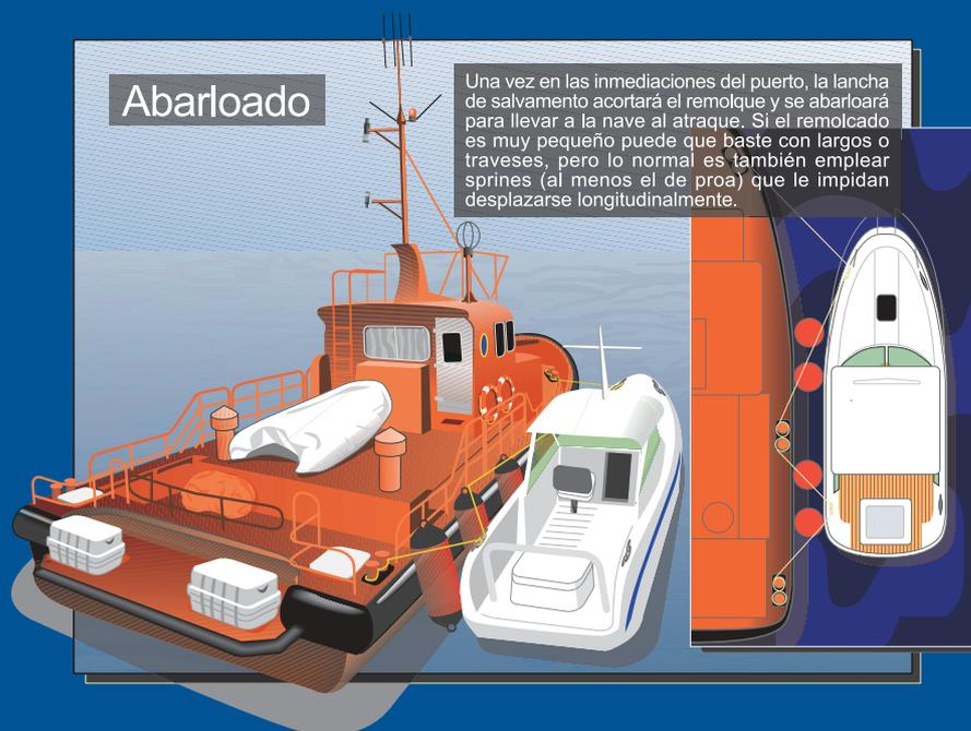
lancha de salvamento. En navegación es normal que vaya muy largo, con una curvatura a la que se llama catenaria que incluso puede sumergir parte del cabo en el agua, saliendo a la superficie de vez en cuando. Esta disposición amortigua gran parte de las tensiones a las que se ve sometido el cabo, que si son muy acusadas pueden romper gateras, cornamusas, incluso el balcón. Ade-
