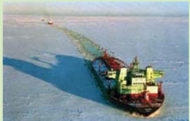
▲ El rompehielos finlandés "Tempera" (con *double acting vessel*) navega hacia atrás. Por supuesto, no tiene timón.
