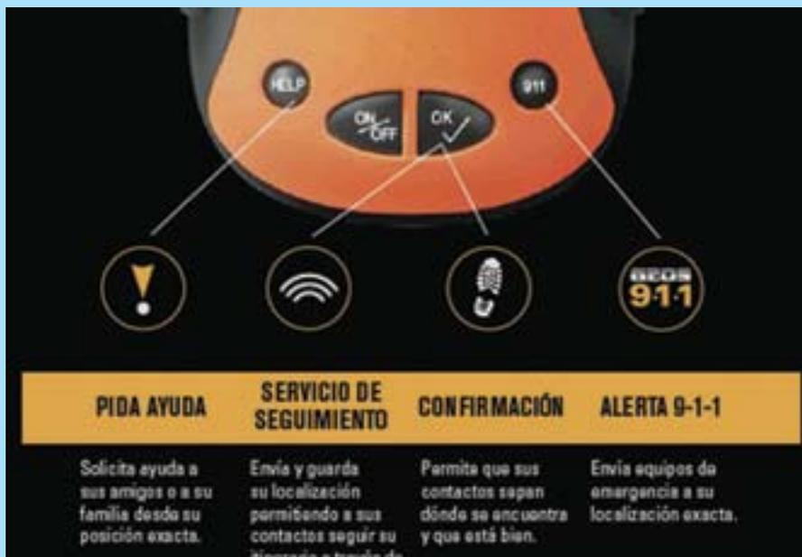
▲ Figura 5. Disposición de la botonadura del equipo portátil SPOT.
