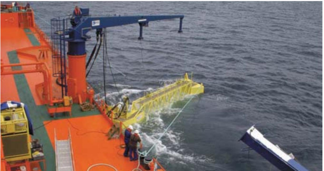
▲ Para el desarrollo de sus funciones, el "Urania Mella" dispone de diversos equipos, entre los que destacan dos brazos flotantes para recogida de hidrocarburos y sendas grúas sobre pedestal.
