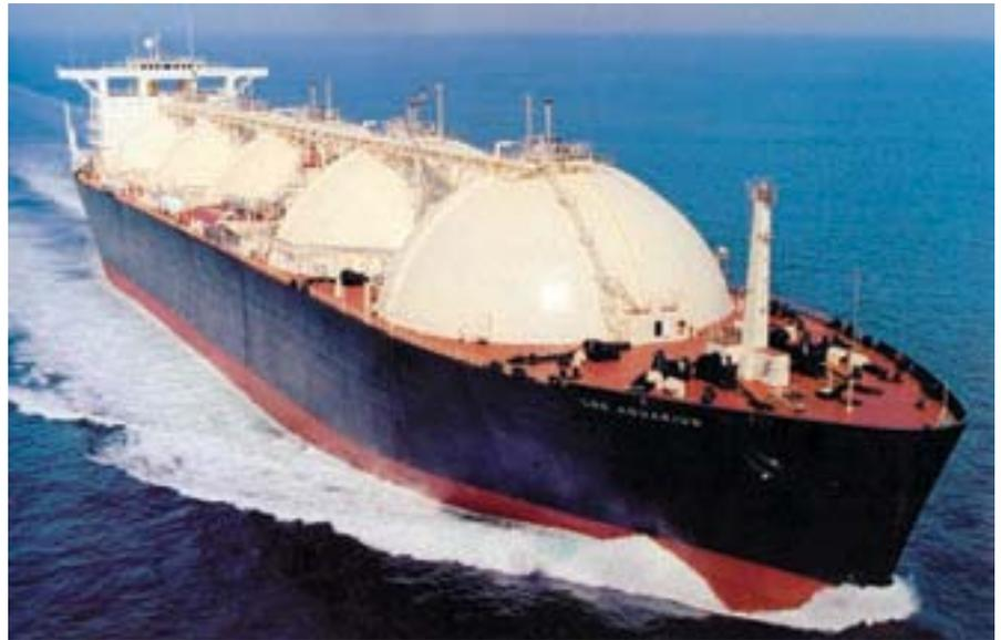
▲ LNG con tanques esféricos. El "Aquarius", encargado a los astilleros de General Dynamics por la nigeriana Bonny Gas Transport (BGT) en 1977. Dispone de cinco tanques esféricos Moss. Se observa la sobre elevación del puente para superar la altura de los tanques.
