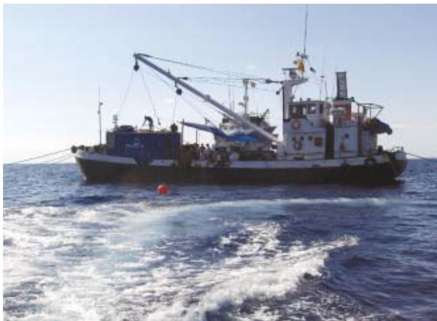
▲ Buque de apoyo a los buceadores "Buffel". En el mismo se aprecia el contenedor con el sistema de circuito cerrado de televisión, regulación de aire y cámara de descompresión.
