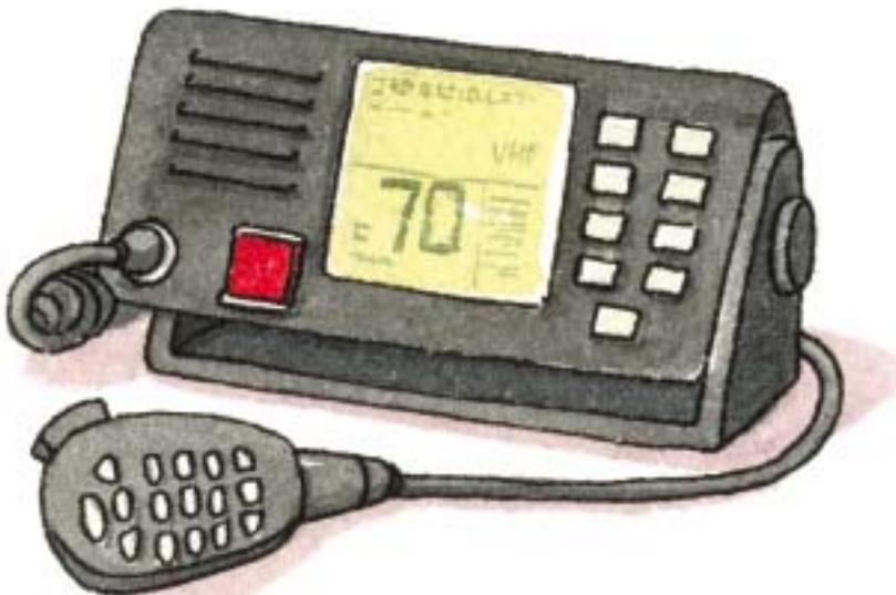
▲ Transceptor de VHF en el que se aprecia el botón rojo de llamada de socorro.
