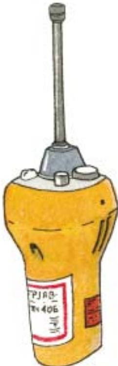
▲ Radio baliza COSPAS-SARSAT de activación automática con GPS.
