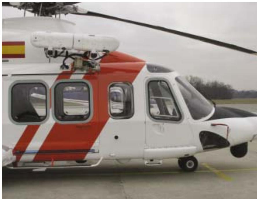
▲ Detalle de la grúa de izado, con capacidad hasta 270 kilogramos y de la burbuja para el observador.
