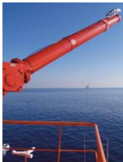
Hasta 4.170 metros cúbicos de agua a la hora pueden accionar cada una de las dos bombas contra incendios del sistema Fire Fight (FI-FI) del buque. El agua es lanzada a una distancia de 160 metros y a 70 metros de altura.
