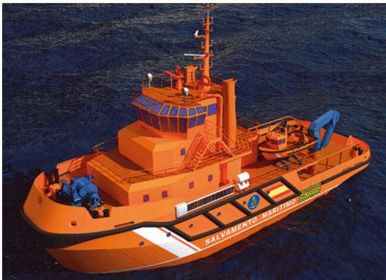
Modelo de uno de los cuatro nuevos buques remolcadores, que tendrán una eslora de 39,7 metros y una potencia de tiro de 60 toneladas.
