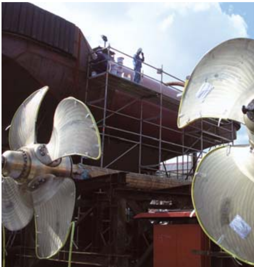
Equipo propulsor principal del BS "Don Inda" antes de su montaje.
