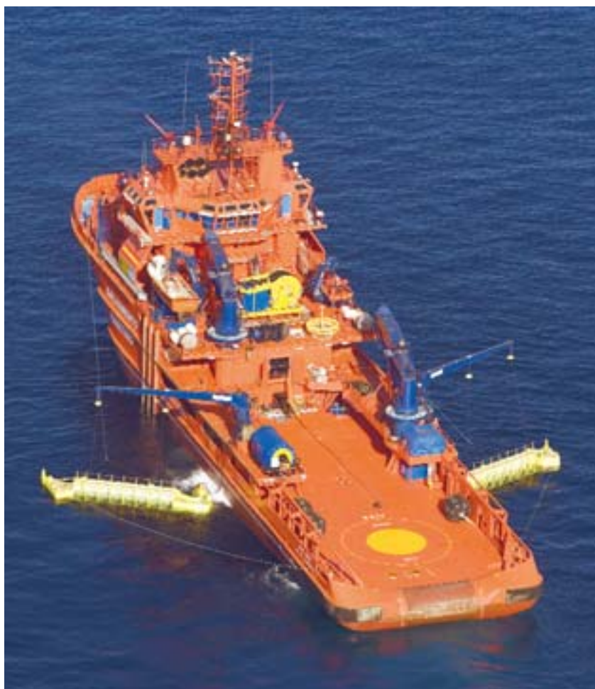
El BS "Don Inda" dispone de brazos flotantes para la recogida de hidrocarburos al igual que el BS "Luz de Mar".
