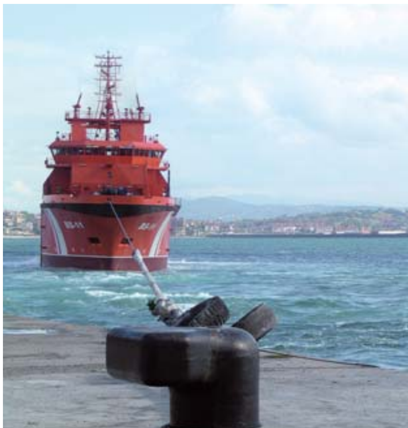
Pruebas de potencia de tiro a punto fijo del BS “Don Inda” realizadas en la antedársena del puerto de Bilbao.
