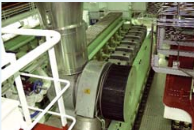
El BS “Don Inda” dispone de cuatro motores Bergen que suministran 21.760 HP de potencia total máxima continua (MCR) a 750 r.p.m.
