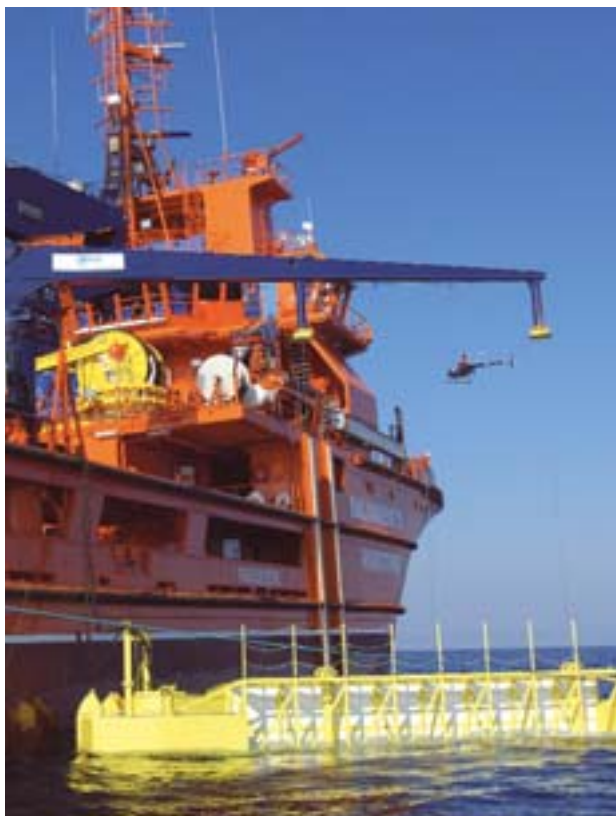
Equipos de recogida de hidrocarburos al costado del BS “Don Inda”.
