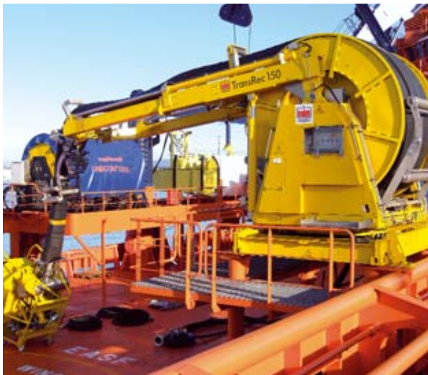
Grúa del "skimmer" tipo FRAN MOHN, modelo TransRec 150, con capacidad de bombeo de 400 metros cúbicos a la hora.
