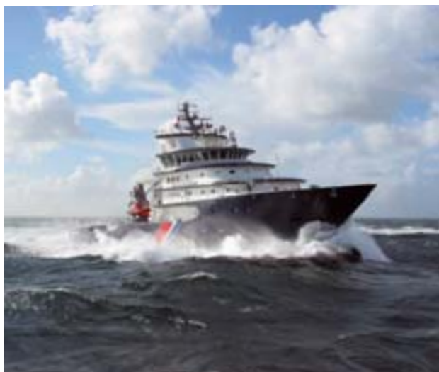
Construido en 2005, el “Abeille Bourbon” es un UT 512, con bollard pull de 201 Tm.
