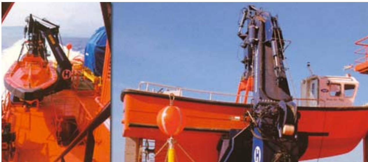
El buque cuenta con dos embarcaciones auxiliares: una para labores de rescate y salvamento, con propulsor waterjet de 200 H.P. que desarrolla 33 nudos, y otra para recogida de residuos, tendido de barreras, remolque de equipos auxiliares, etc. Su tiro a punto fijo es de 2 mts.
