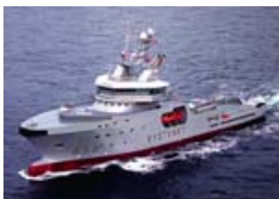
El Coastguard de Noruega dispone de un UT 512, el "KV Harstad", con bollard pull de 110 Tm y 1.000 metros cúbicos de capacidad en sus tanques de almacenamiento de residuos de hidrocarburos.
