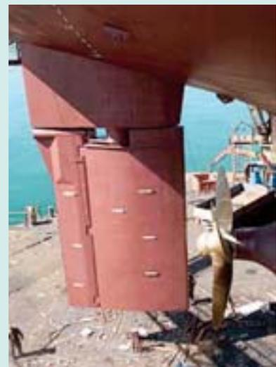
Figura 4. Foto del timón de aleta que lleva instalado el petrolero de 46.000 DWT "Minerva Julie", que entró en servicio en el año 2000.
