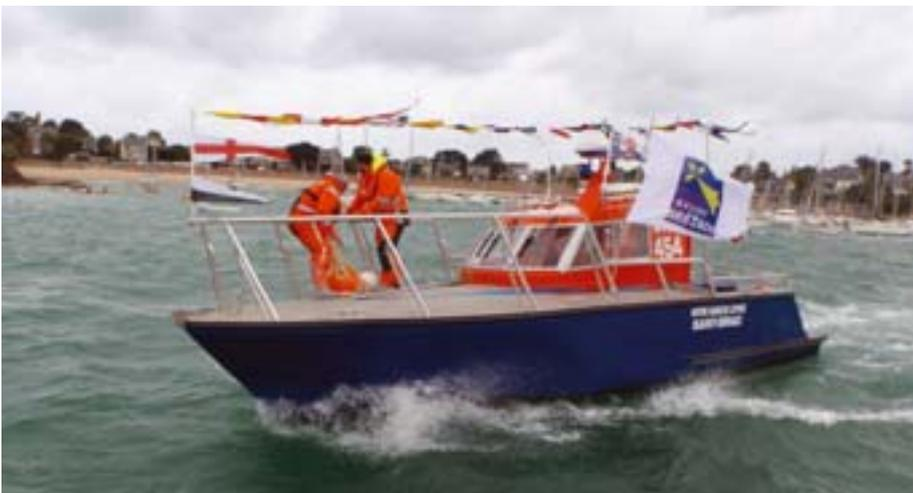
> La “Notre Dame de l’Epine” (SNS 454) es una VSL de 9 metros con casco de aluminio y propulsada por dos motores fueraborda, construida por *Gosselin*. (Foto: SNSM.)
