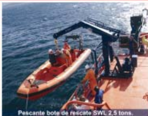
Pescante bote de rescate SWL 2,5 tons.
