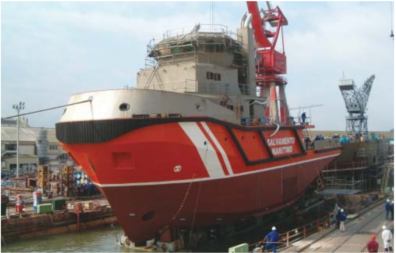
▲ Botadura del "María Zambrano". Puede observarse en la proa la estacha para ayudar con un tirón de otro remolcador su caída al agua. (Foto UNV.)
