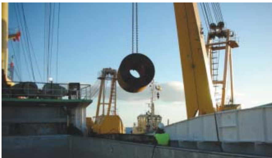
▲ Aligerando la carga. La pontona “Pidesa 3” descarga bobinas de acero de la bodega número 1 con objeto de reflotar el buque.
