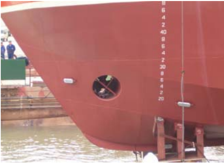
▲ Vista de la proa y de la hélice transversal allí situada. (Foto UNV.)
