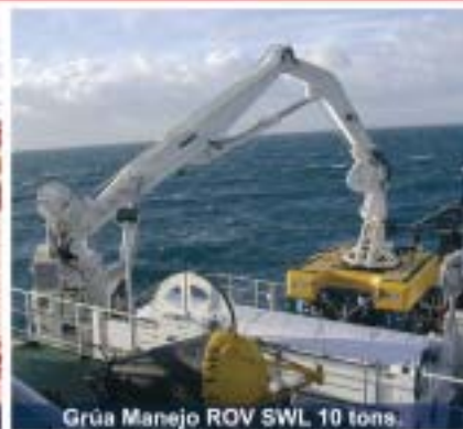
Grúa Manejo ROV SWL 10 tons.
