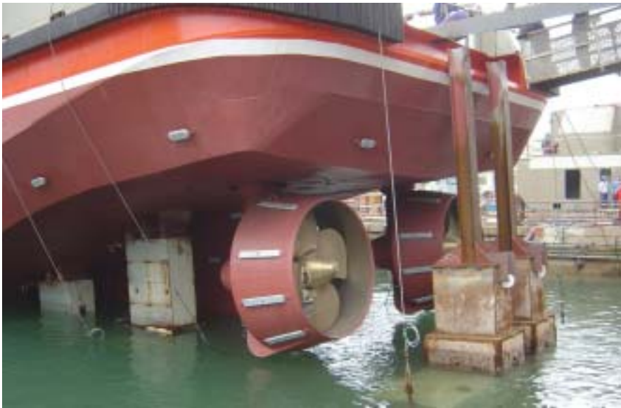
▲ Con las protecciones para la botadura, los propulsores azimutales del “María de Maeztu”. (Foto UNV.)
