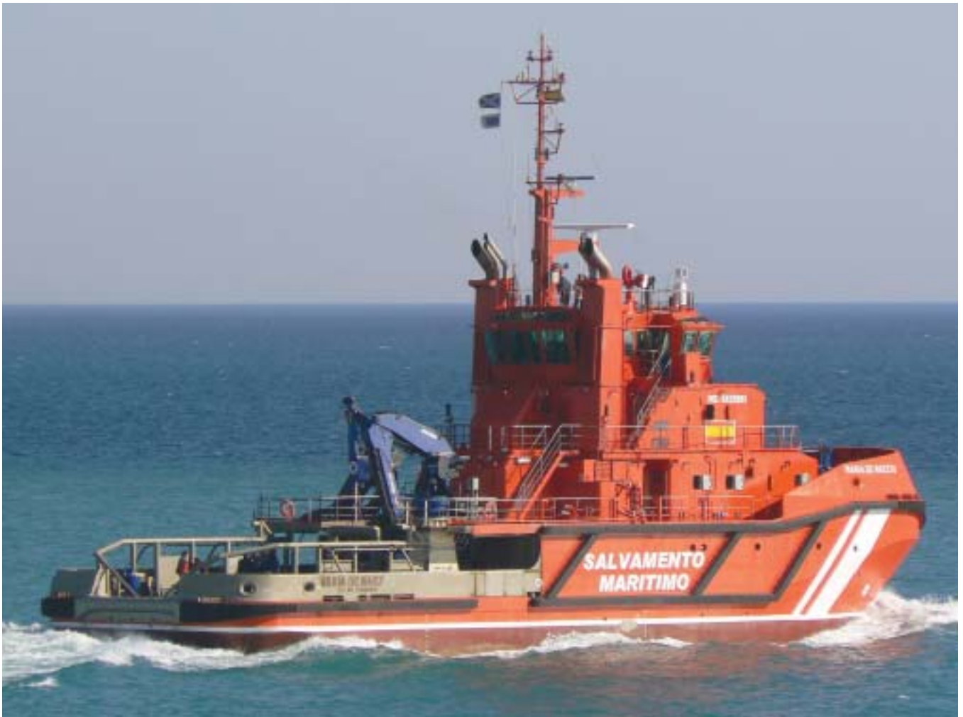
▲ En esta vista se puede observar la cubierta de popa y la grúa hidráulica del “María de Maeztu”. (Foto: Manuel HERNÁNDEZ LAFUENTE.)
