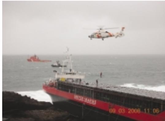
Durante las primeras horas tras la embarrancada, se preparó la maniobra de reflotamiento del "Maro" aprovechando la marea de 4 metros de amplitud. La situación estructural del buque, aún con daños importantes en los tanques de doble fondo y sala de máquinas, parecía permitir dicha maniobra.
