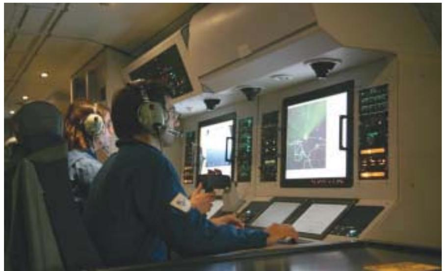
▲ Vista de dos consolas del sistema FITS con sus pantallas planas de 20 pulgadas. (Foto: EADS CASA.)
