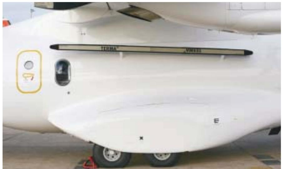
▲ Detalle de una de las dos antenas del radar SLAR de Terma. (Foto: EADS CASA.)
