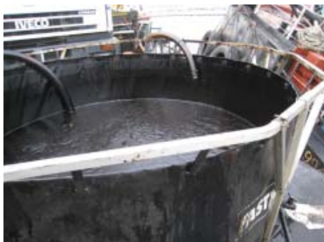
▲ Decantación de fuel en fast-tank.
