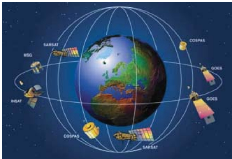
▲ El Sistema COSPAS-SARSAT combina satélites polares y geoestacionarios.
