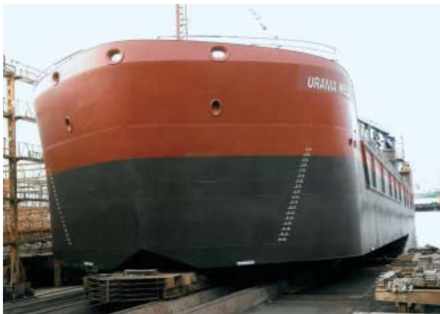
▲ El "Urania Mella" presenta una proa redonda, apropiada para navegación en aguas cerradas en bahías o puertos. (Foto: ASTILLEROS CARDAMA.)
