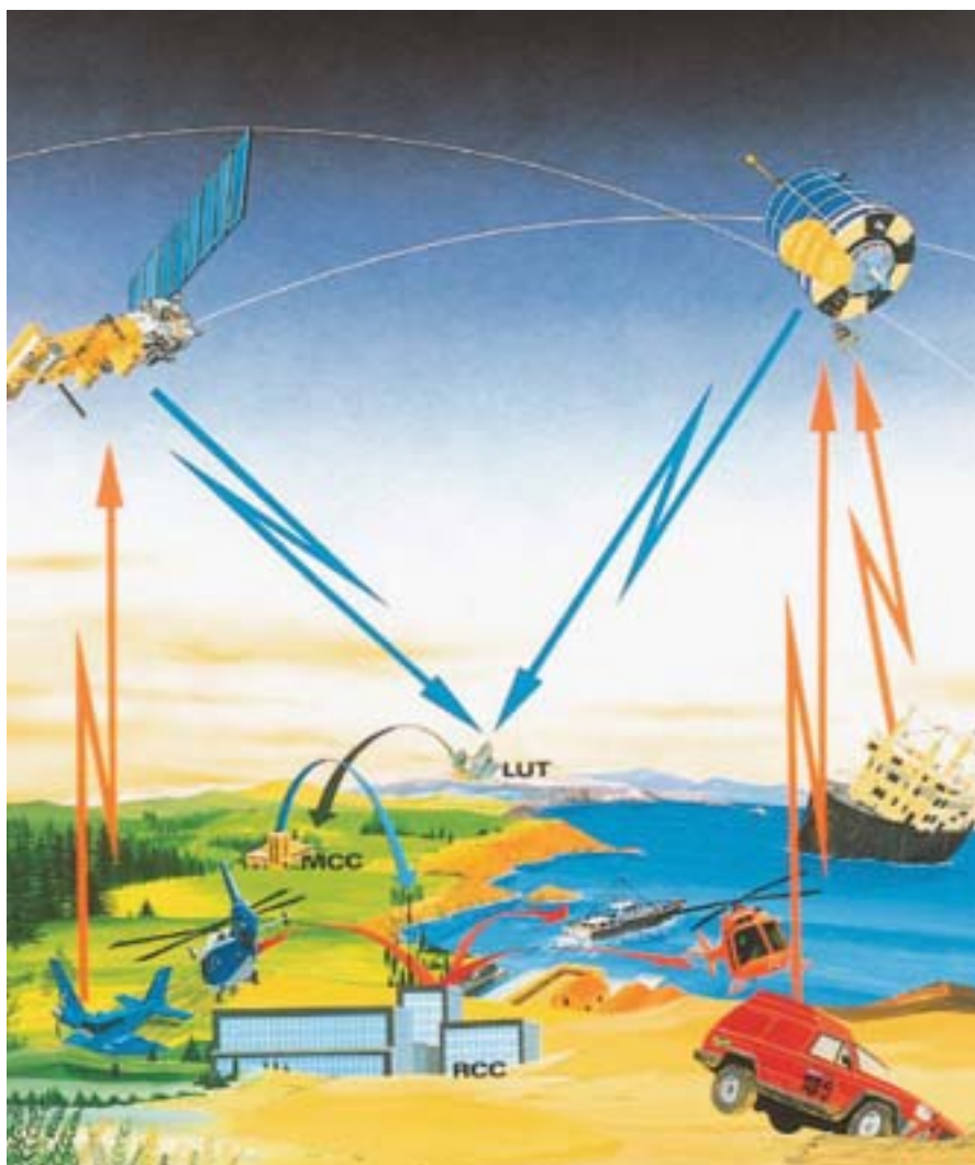
▲ Diagrama de funcionamiento del Sistema COSPAS-SARSAT.
