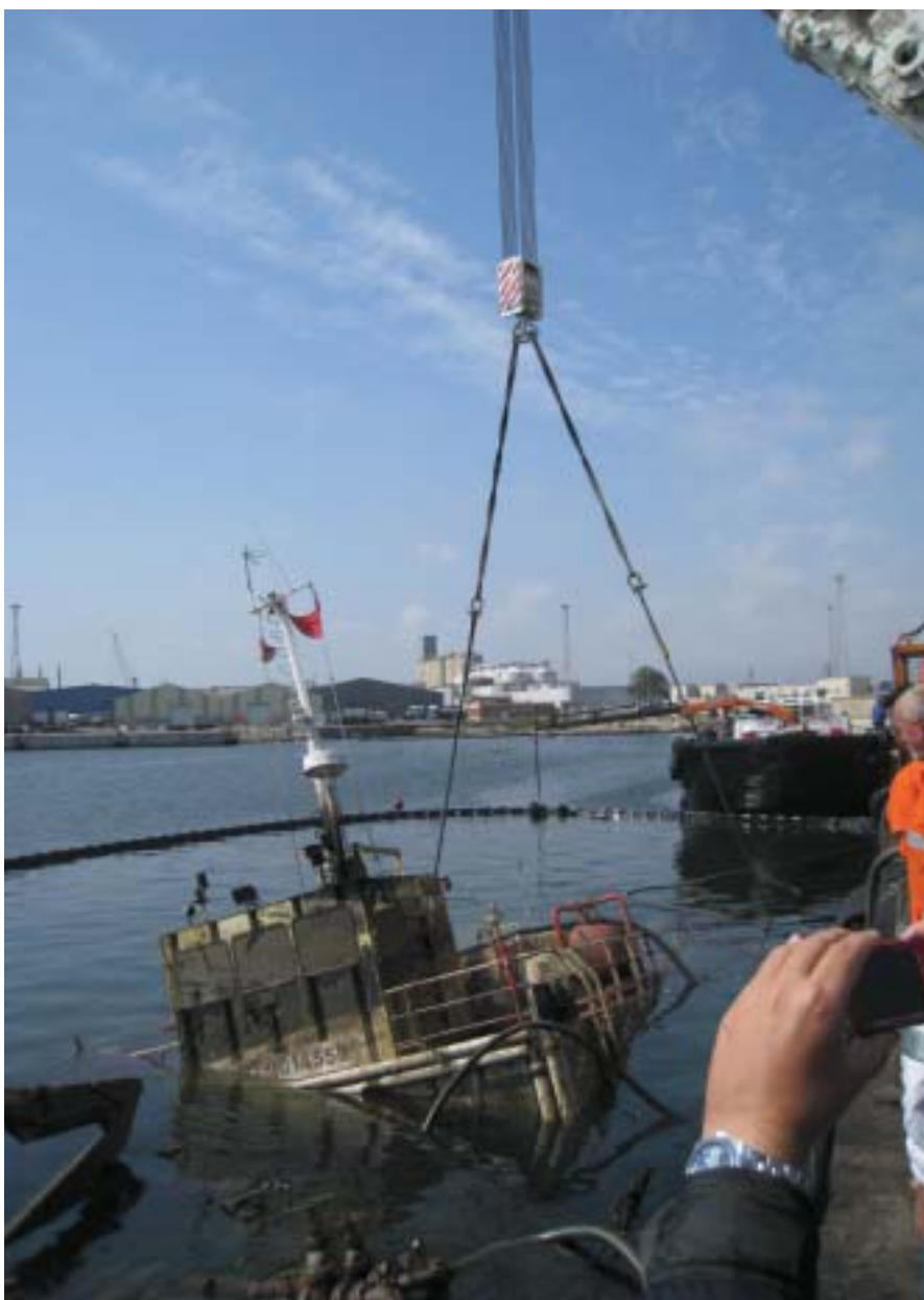
▲ El aire inyectado comienza a reflotar la gabarra.
