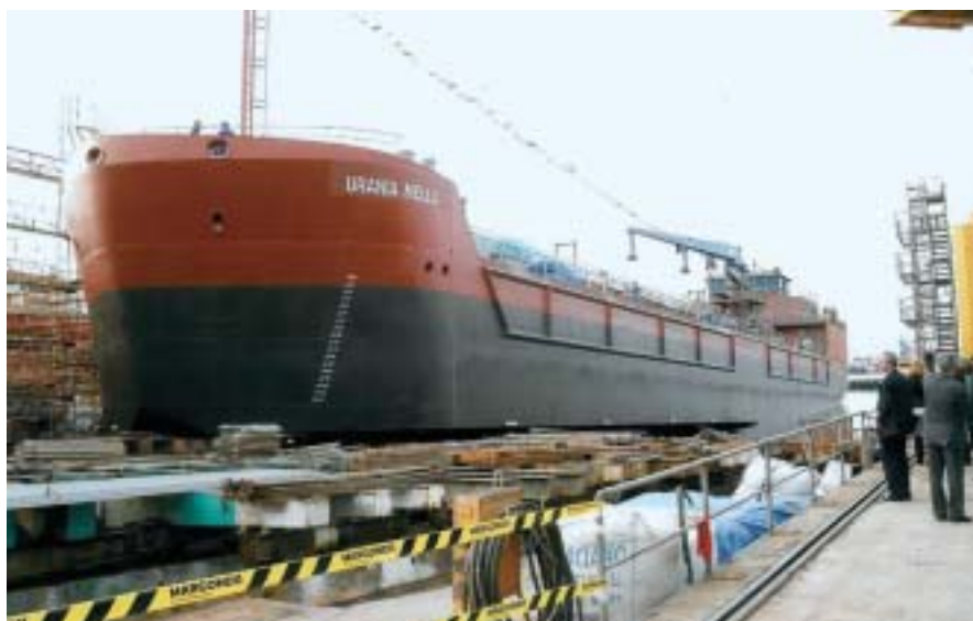
▲ El buque recogedor "Urania Mella" deslizando por la grada camino de las aguas de la ría de Vigo. (Foto: ASTILLEROS CARDAMA.)
