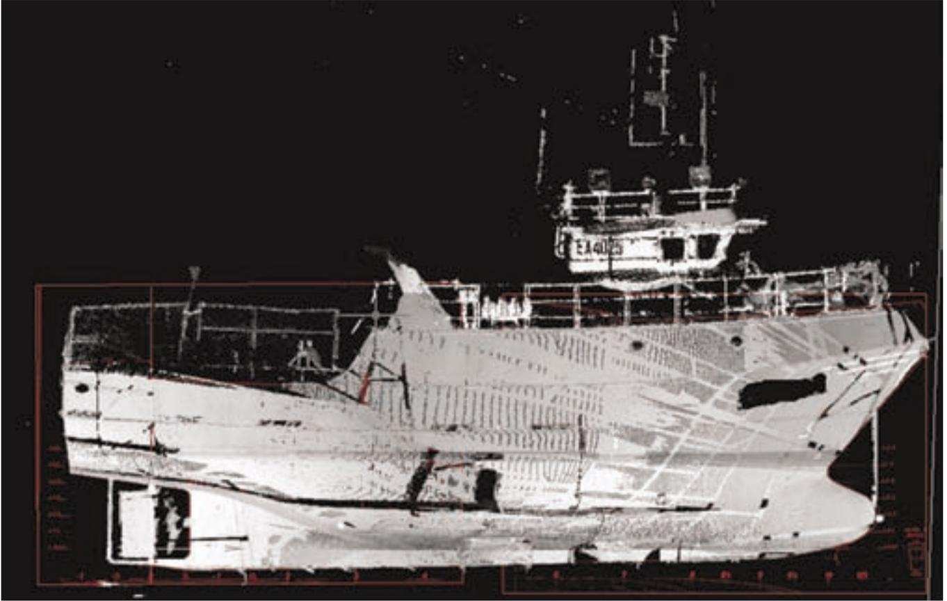
▲ Figura 1. Nube de puntos en 3D mirada de costado con el plano de formas de imagen de fondo.
