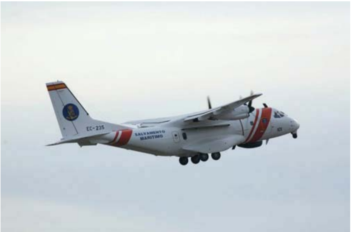
▲ En esta foto del despegue de un CN-235 de Salvamento Marítimo se puede observar claramente el tren de aterrizaje, la torreta del FLIR en la parte delantera, la antena del radar de exploración y el radar SLAR bajo el ala. (Foto: EADS CASA.)
