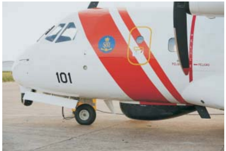
▲ En esta foto se aprecia, detrás de la rueda delantera del avión, el domo del radar de exploración. (Foto: EADS CASA.)
