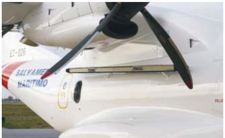
▲ Al lado del portillo de salida de emergencia, se puede observar una de las ventanas dotadas con burbuja de observación. (Foto: EADS CASA.)
