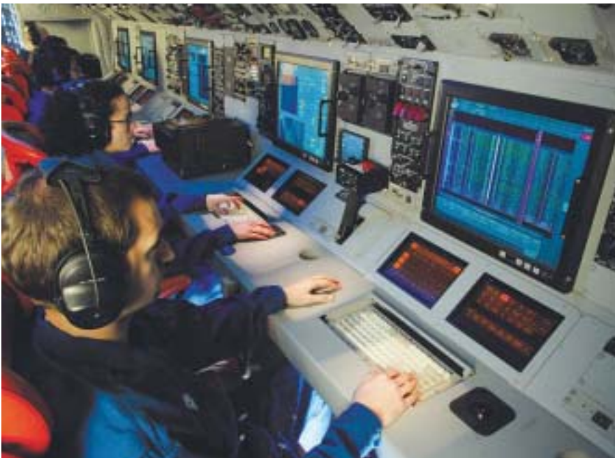
▲ En esta fotografía se muestra una instalación de FITS en un avión de patrulla marítima, con cinco consolas y pantallas. (Foto: EADS CASA.)
