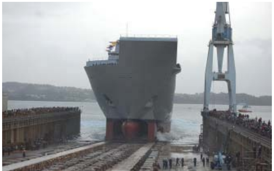
▲ Casi a punto de estar completamente a flote. Obsérvese el ski jump en proa y los cajones auxiliares de flotación. (Foto: ARCHIVO Mdr ALMIRANTE DE CASTILLA.)
