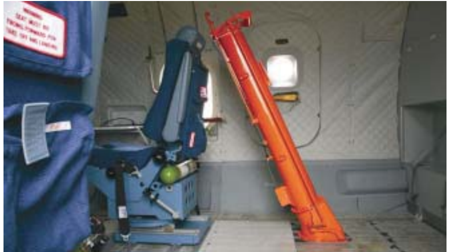
▲ En la parte posterior de la cabina se encuentran los asientos de observación y el lanzador de bengalas y marcadores. (Foto: EADS CASA.)
