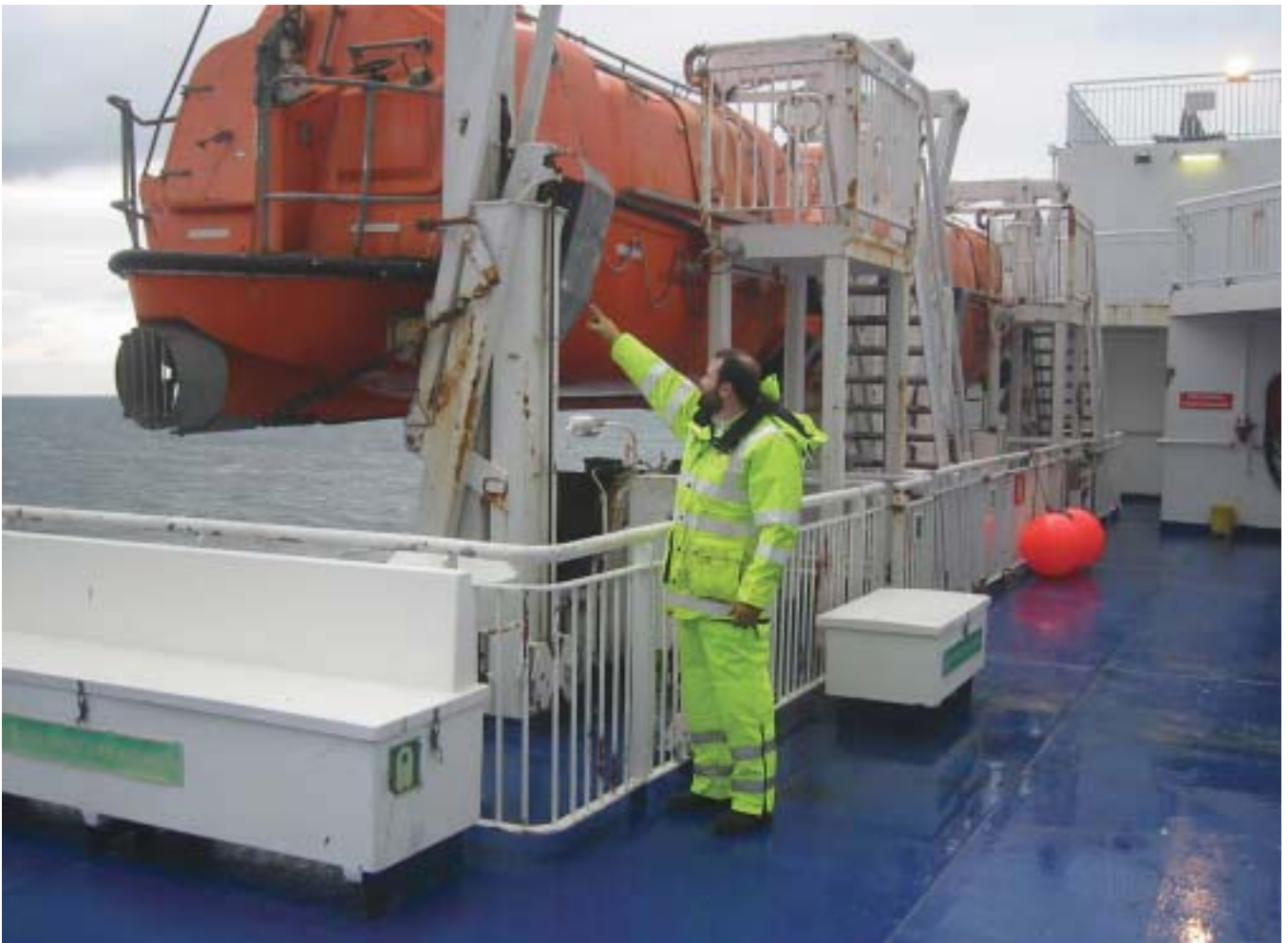
▲ Pescante con indicaciones de poco uso y falta de mantenimiento.
