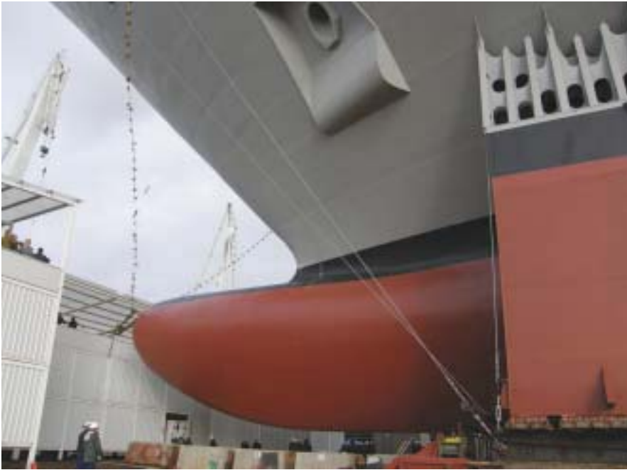
▲ Bulbo de proa. Se pueden apreciar los cajones de flotación instalados para la botadura. (Foto: Francisco Javier ÁLVAREZ LAITA.)
