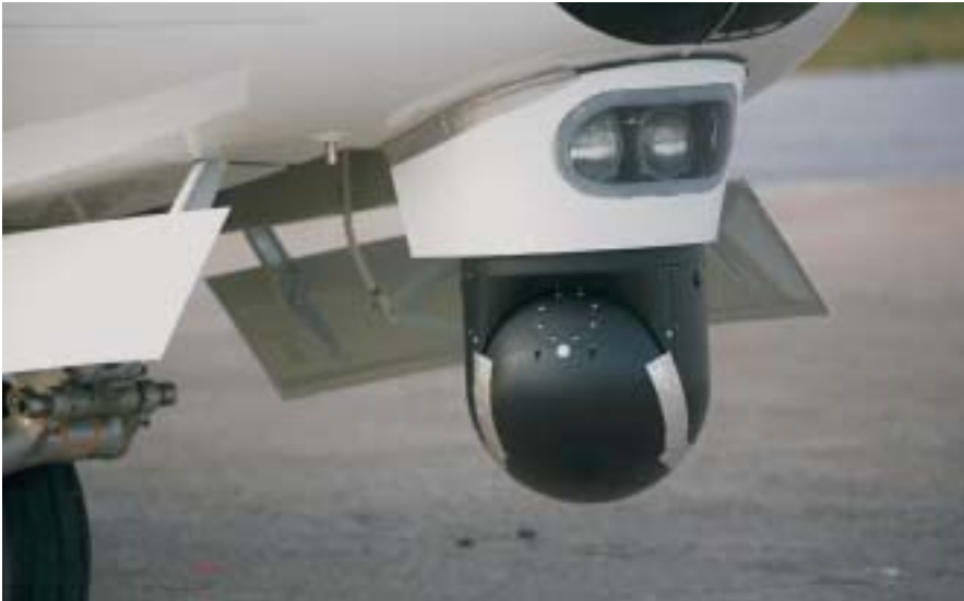
▲ Detalle de la torreta FLIR de un Persuader de Salvamento Marítimo. (Foto: EADS CASA.)
